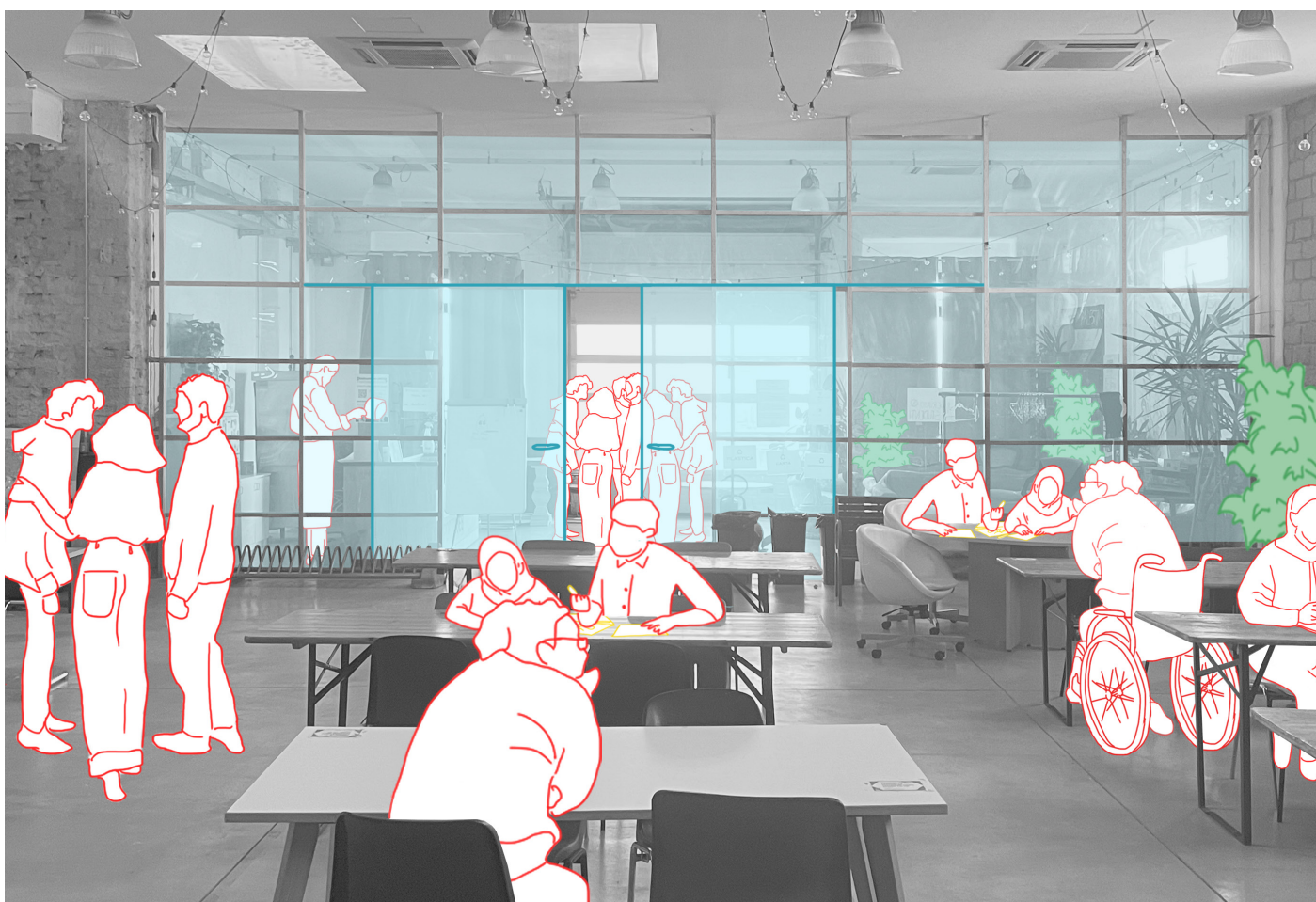
Opzione 2: parete con elementi in plexiglass o policarbonato con due porte scorrevoli
